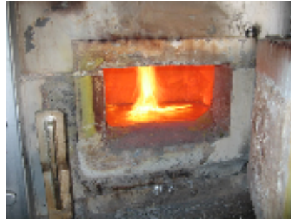
これを炉に入れ熔解します。伸和ではLPガスを 使用。メンテ以外は、24時間加熱し続けます。
