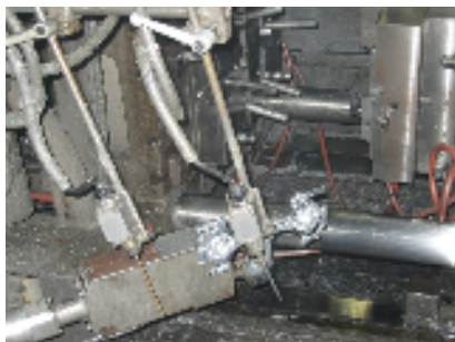
ロボットが成型品を取出しベルトコンベアに乗せます。
