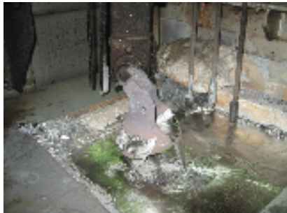
インゴットが熔解した様子です。670~690℃ に達します。パット見、熔けているようには 見えませんがドロドロです。ラトル（ひしゃくの様な物） でロボットが汲み上げ、金型に注入していきます。
